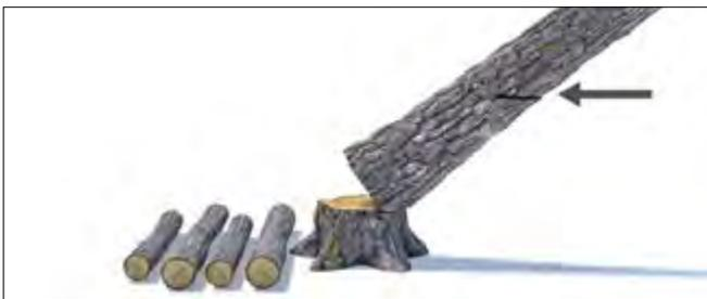
Sägen Sie den Stamm von hinten bis ungefähr auf die Hälfte des Durchmessers durch. Fahren Sie mit dem Sägen von der anderen Seite fort, wenn die Schiene kürzer ist als der Baumdurchmesser.
