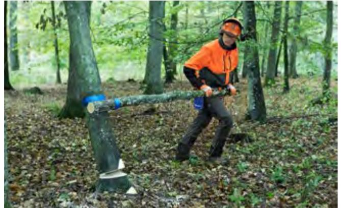
Nehmen Sie den Wendehaken (oder den Wenderiemen, um einen Ast als Hebel anzubringen) und lassen Sie den Baum niemals in Ihre Richtung rollen. Heben Sie gerade nach oben mit geradem Rücken und gebeugten Knien. Wenn der Baum groß ist oder sehr fest hängt, können Sie die Rollkraft verstärken, indem Sie einen Wendehaken oder einen Wenderiemen mit einem längeren Stück eines dünnen Baums verwenden.
