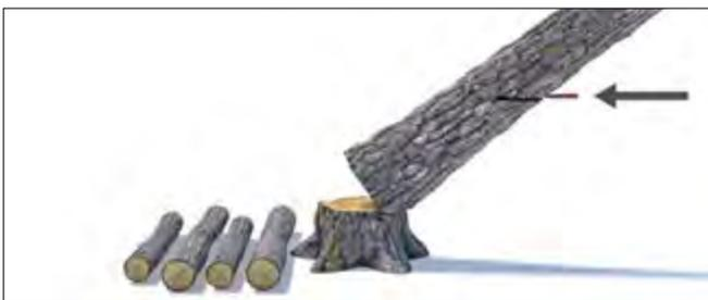
Setzen Sie einen Keil ein, um zu verhindern, dass der Schnitt zusammengedrückt wird.
