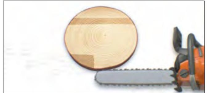
Continuez à scier vers l'arrière jusqu'à ce que les deux tiers du tronc soient sciés. Ramenez le guide-chaîne pour réaliser un talon de 5 à 10 cm de large. Continuez ensuite à scier jusqu'à ce que vous ayez traversé le tronc. Il ne reste alors qu'un talon de bois non scié. Le talon doit avoir à peu près la même surface totale que la charnière.
