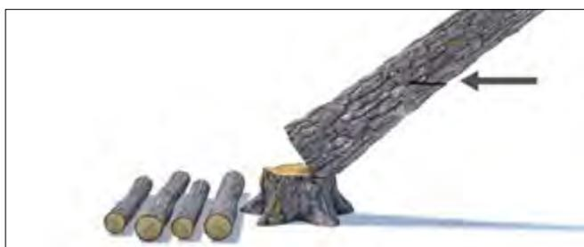
Réalisez une entaille sur environ la moitié du diamètre du tronc par l'arrière. Continuez le sciage de l'autre côté si le guide-chaîne est plus court que le diamètre de l'arbre.
