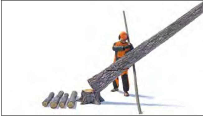
Si l'arbre encroué ne s'est pas détaché en frappant sur le coin : Poussez l'arbre à l'aide d'un bâton/perche de 2 à 3 m de long dans le sens de déplacement jusqu'à ce qu'il se détache et glisse vers le bas.
