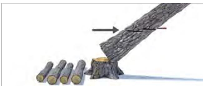
Sciez la prochaine entaille par devant, parallèlement à la coupe précédente, mais 3 à 5 cm en dessous. Réalisez une entaille sur environ la moitié du diamètre du tronc. Effectuez un chanfrein sur le devant du tronc.
