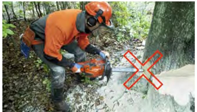
Il existe un risque de rebond avant l'abatage proprement dit lorsque vous ébranchez le dessous du tronc et enlevez les broussailles qui gênent le travail d'abatage. Travaillez avec une chaîne en traction (partie inférieure du guide-chaîne) lors de l'élagage. Ne jamais scier au-dessus de la hauteur des épaules.
