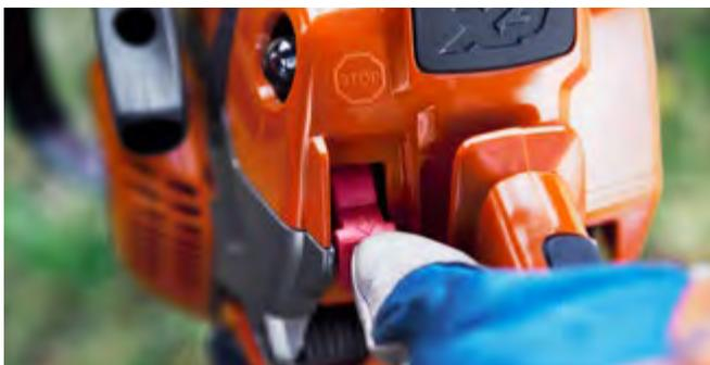
La commande d'arrêt doit se trouver à un endroit facile d'accès sur la tronçonneuse afin que le moteur puisse être arrêté rapidement dans une situation critique.
