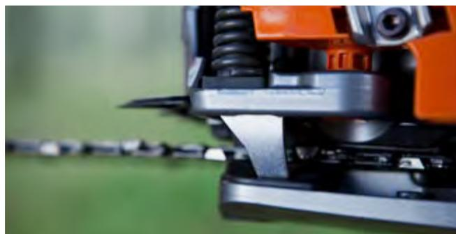
L'attrape-chaîne permet de retenir la chaîne en cas de bris ou de décrochage.
