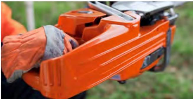
Le protège-main droite est prévu pour protéger la main de l'utilisateur en cas de rupture ou de déraillement de la chaîne.
