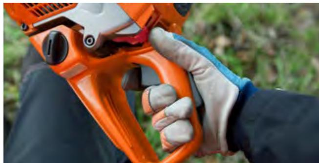
Le blocage de gâchette d'accélérateur est conçu pour empêcher toute accélération accidentelle. La gâchette ne fonctionne que si le verrou est enfoncé, c'est-à-dire si vous tenez la poignée arrière de la tronçonneuse avec une prise ferme tout en accélérant.
