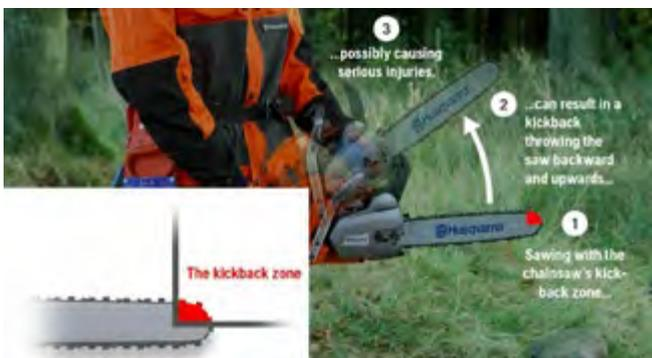
Le bord supérieur de l'extrémité du guide-chaîne constitue la zone de rebond. L'utilisation de cette zone en cours d'opération, augmente le risque de rebond. Lorsque la zone de rebond de la chaîne entre en contact avec le bois, la chaîne « accroche » et l'outil tout entier est repoussé violemment vers
