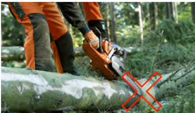
Soyez prudent lors d'ébranchage. Le nez de la guide-chaîne peut heurter des bûches, des souches, des branches cachées et des extrémités de bûches sous-jacentes, provoquant ainsi un rebond.
