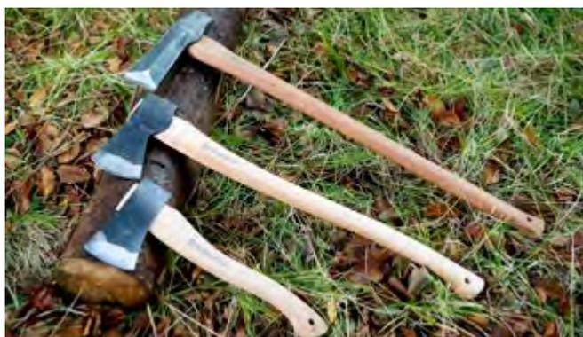
Servez-vous d'une hache pour enlever l'écorce, la mousse et le sable du tronc avant de le couper, car cela réduira l'usure du guide-chaîne et de la chaîne. La hache peut aussi être utilisée pour enfoncer les coins d'abattage.
