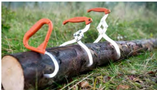
Un crochet de levage sert à soulever et tourner les rondins. Les pinces de levage permettent de soulever et de déplacer les rondins les plus petits ainsi que le bois de chauffage et le bois à pâte. Pour une bonne prise des rondins, il est très important que les crochets et les pinces de levage soient bien affûtés.
