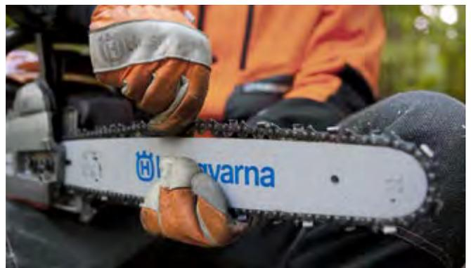
Assurez-vous que la chaîne est correctement tendue. Une chaîne détendue peut sauter du guide-chaîne, provoquer des blessures et endommager la tronçonneuse. Une chaîne détendue – ainsi qu'une chaîne trop tendue – peut également provoquer une usure prématurée du guide.
