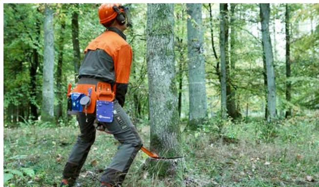
La barra desgajadora está disponible con mangos de diferente longitud, lo cual ofrece varios niveles de fuerza para el derribo. Evita utilizar barras desgajadoras con un mango demasiado largo en árboles muy gruesos y muy inclinados hacia atrás, ya que se necesitará una elevación demasiado alta y no podrás con ello. Altura de elevación máxima: unos 2 cm.
