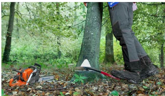
La barra desgajadora de pedal es ideal para trabajos de clareo y para árboles pequeños. Introduce la barra desgajadora de pedal antes de terminar el corte de derribo. Aplica todo tu peso sobre el brazo de palanca. La barra desgajadora de pie suele ser telescópica y se puede transportar en una funda del cinturón portaherramientas.
