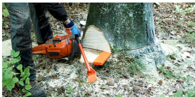
La barra de impacto tiene la misma función que la barra desgajadora. También se puede utilizar para golpear las cuñas a la hora de introducirlas en el corte.
