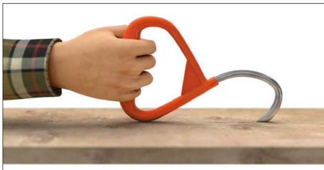
Para comprobar el funcionamiento de la punta, tira del gancho en paralelo a las vetas de la madera ejerciendo una ligera presión en el mango; utiliza para ello un tablero de madera o un tronco sin corteza. Si la punta está bien afilada, se enganchará firmemente a la madera y realizará una suave hendidura.
