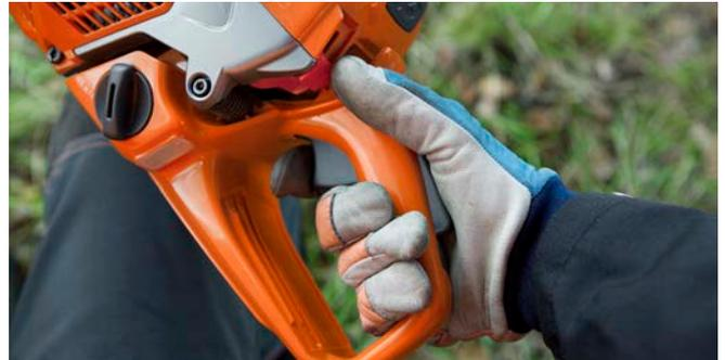
El fiador del acelerador se ha diseñado para prevenir el accionamiento accidental del acelerador. El acelerador funcionará solamente cuando se pulse el fiador, es decir, si sujeta firmemente el mango trasero de la motosierra mientras acciona el acelerador.
