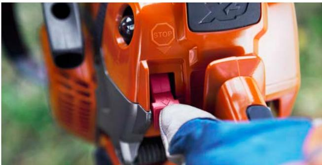
El control de parada debe encontrarse en un lugar fácilmente accesible de la motosierra para poder parar el motor rápidamente en caso de emergencia.
