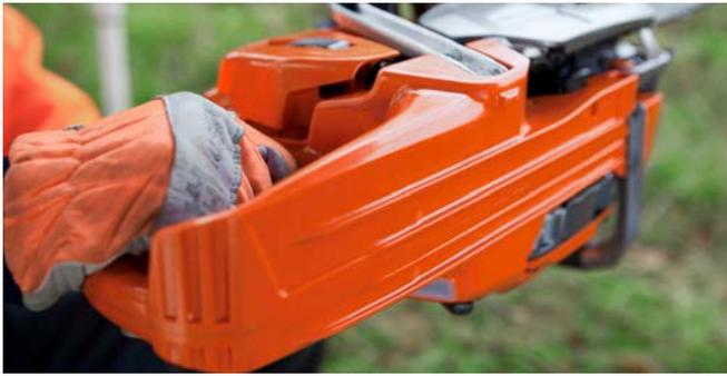
La protección para la mano derecha se ha diseñado para proteger la mano del operario en caso de que la cadena se rompa o se salga.
