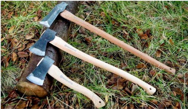
Utiliza un hacha para quitar la corteza, la tierra y la arena del tronco antes de cortarlo a fin de reducir el desgaste de la espada y la cadena. El hacha también sirve para golpear las cuñas.
