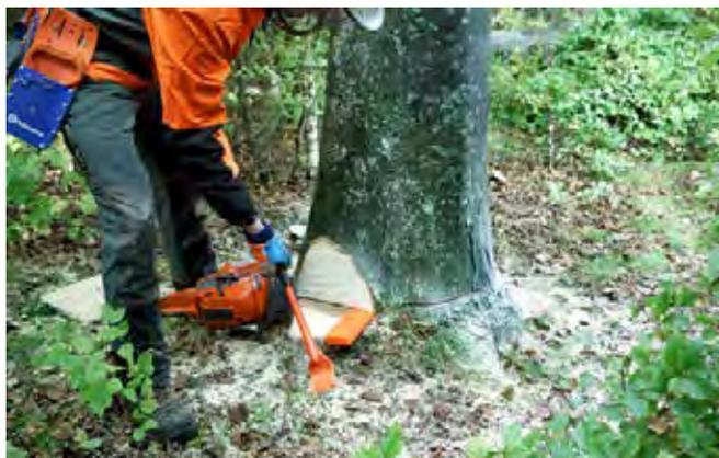
伐採クサビは木を起こす力が大きいので、中径木から大径木に最適です。追い口が完成する前にクサビを挿入して、斧やハンマー、インパクトバーで打ち込みます。複数のクサビが必要となる場合があります。プラスチックやアルミニウムなどの柔らかい素材でできたクサビの使用をお勧めします。クサビに切り込んでしまった場合でも、チェンを損傷するおそれはありません。追い口の最大持ち上げ高さ:約 50~60 mm。(クサビの種類、使用方法によって持ち上げ高さは異なります。道具の使い方等は国内の法令に従って使用してください)
