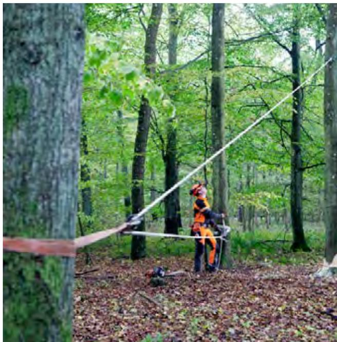
ロープとウインチを使用して木を下ろすと、安全性が向上し、効率よく作業ができます。ロープとウインチは、枯れた木を引き下ろす場合や、かかり木を処理する場合などに役立ちます。伐倒方向を強制的に決める場合にも使用できます。木のサイズによって、作業に必要なロープ(またはケーブル)の強度が決まります。
