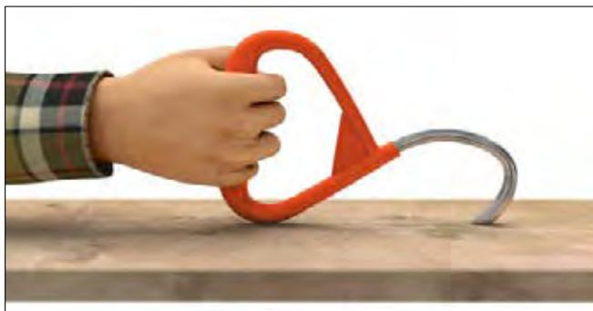
木板または樹皮のない丸太の木目に沿って、ハンドルを軽く押しながら水平に引っ張ることで、先端の機能を点検します。先端が適切に研がれていると、木に均等に付き、かすかに溝を刻みます。
