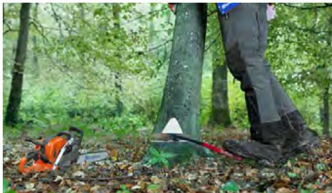
ブレイキングバー（足踏み式）は、間伐や除伐などの小径木用に適しています。追い口が完成する前に、ブレイキングバー（足踏み式）を挿入してください。レバーアーム上に立って、全体重を乗せます。この使用法は小径木以外では禁止されている場合がありますので、日本の法令をご確認ください。通常、ブレイキングバー（足踏み式）は伸縮式で、ツールベルトのホルスターに収納できます。
