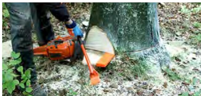
インパクトバーは、ブレイキングバー（フェリングレバー）と同じ用途で使用されます。また、伐採クサビを使用する際に、クサビ打ち込み用ハンマーとして使用します。
