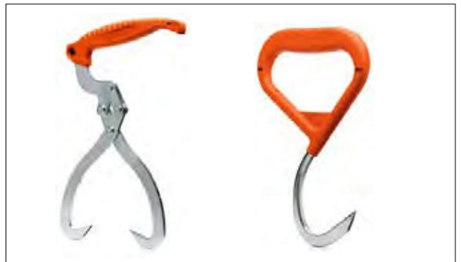
リフティングフックは、木の吊り上げと回転に使用します。リフティングトングは、小さな材木および薪やパルプ材の木片を吊り上げたり、移動したりするのに使用されます。丸太をしっかりと保持するには、トングとフックの先端が尖っていて鋭利であることが非常に重要です。
