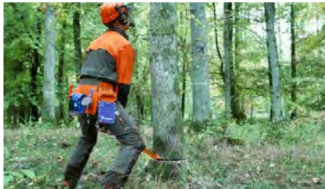
木を起す力が異なるさまざまな長さのブレイキングバー（フェリングレバー）が使用できます。非常に太くて大きく後ろに傾いた木には、ハンドルが長いブレイキングバーを使用しないでください。作業者が対応できる高さを超えて持ち上げなければならない場合があります。追い口の最大持ち上げ高さ:約 2 cm。
