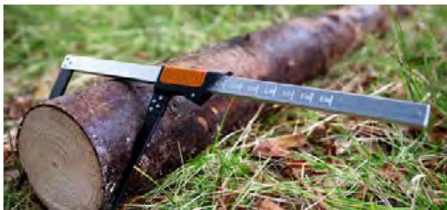
直径を測定し、丸太の体積を計算するための実用的なツールです。
