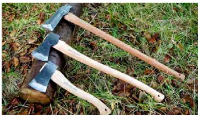
斧を使用して、切削前に丸太から樹皮、土、砂を取り除きます。これにより、ガイドバーやチェンの摩耗を抑えることができます。斧は、伐採クサビを打ち込む際にも使用します。
